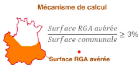
FIGURE 1.10 – Mécanisme de calcul de la surface RGA (Source : Mission Risques Naturels)
