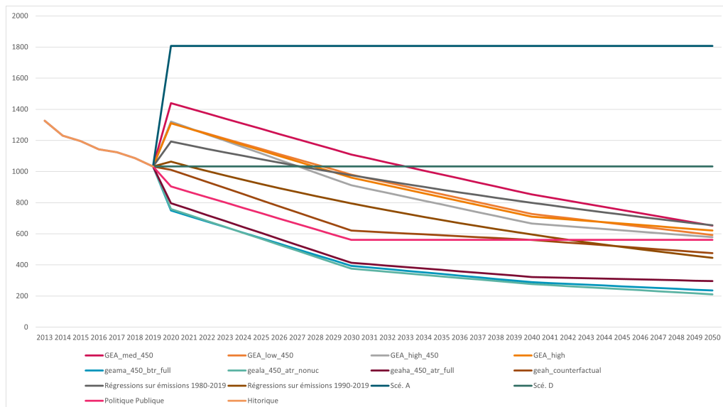
FIGURE 3.4 – Données d'émissions de NO_x historiques et projetées selon les différents scénarios présentés en 3.2.2 et en 3.2.3. On constate que les émissions sont à tendance baissière, excepté pour le scénario réglementaire D qui n'est pas réaliste.
